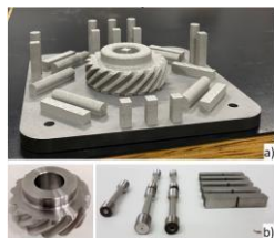
Fig. 1. a) L-PBF, b) Usinagem
